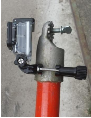
Montasje av kamera på isolerstang.
