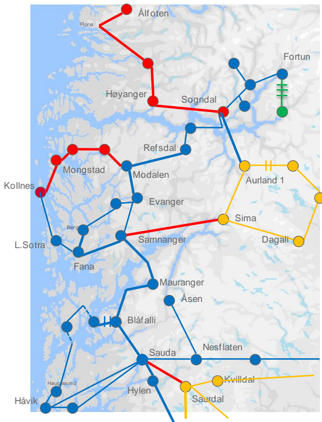
Figur 4-2: Kart over nettet på Vestlandet med forutsetningene i nullalternativet. Røde ledninger viser nye 300 kV og 420 kV ledninger som ikke er idriftsatt i dag.
