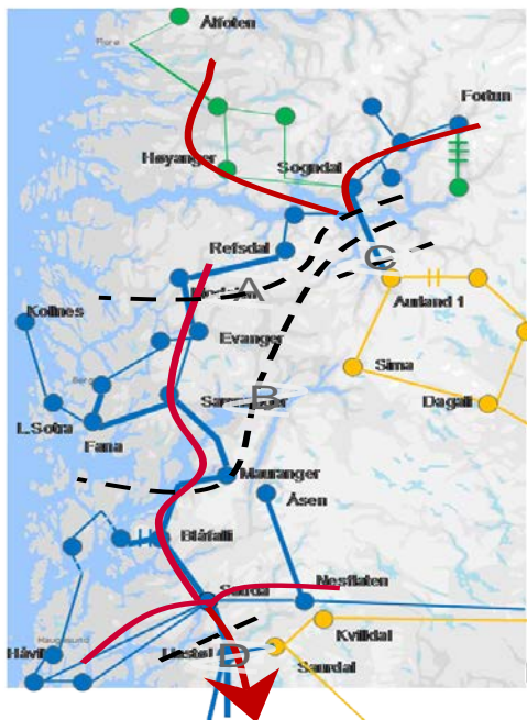
Figur 2-1: Kart over sentralnett på Vestlandet for 2010 med karakteristisk effektflyt i en overskuddssituasjon. Begrensende snitt 3 er inntegnet i kartet og overføringskapasitet i snittene er i tabell.
