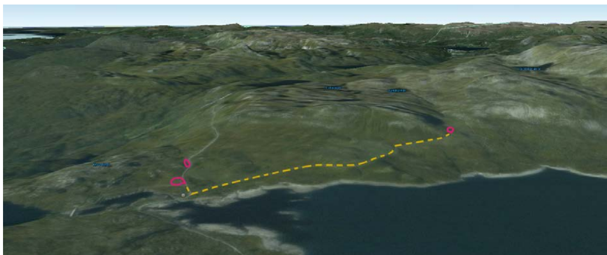
Figur 53 Ved Sandsavatnet vil anleggsvegen følge et eksisterende veganlegg i et slakt skrånende terreng. Tre baseplasser vil bli anlagt med tilknytning til veien.
